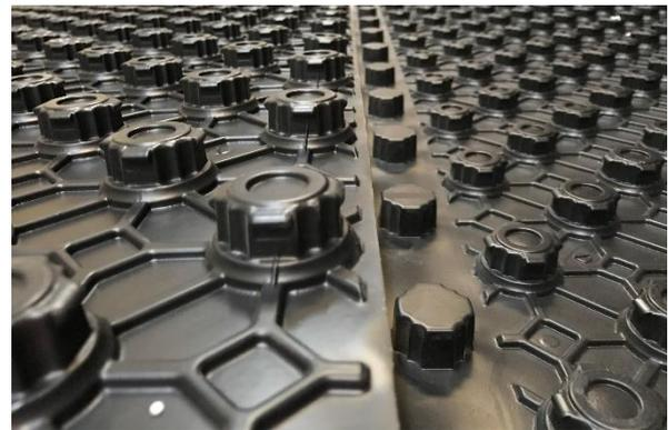
Los "tetones" moldeados que incorpora el panel permiten la instalación y fijación del tubo a un paso regular (múltiplos de 50 mm) de acuerdo con las necesidades térmicas. Los rebajes laterales de los "tetones" evitan que los tubos se separen del aislamiento, quedando el tubo totalmente paralelo con el forjado.
