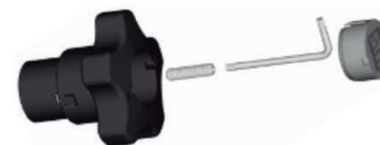
**1-** Usando una herramienta, retire suavemente la tapa de plástico en el centro del volante.
