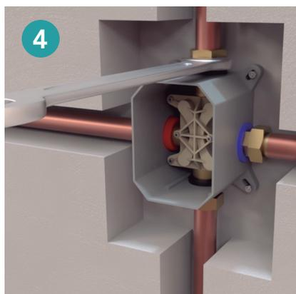
**4** Apretar la tubería y conectores al iClever
